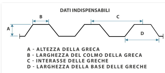
Dettaglio lato perpendicolare al colmo.
